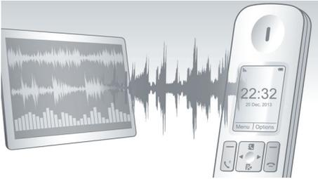
我們以高階耳筒製造商相同的測試方式測試了 DECT 電話的音質。透過進階的耳朵模擬器，我們可以準確地再現人類聆聽的方式。這可以幫助我們的聲學工程師測量以及微調頻率響應、失真和聆聽感覺等等，為手機和免提模式提供最完美的語音再現。
