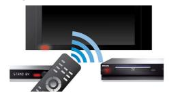
EasyLink позволяет управлять несколькими устройствами — например, DVD-плеерами, проигрывателями Blu-ray, саундбарами (звуковыми панелями), домашними кинотеатрами, телевизорами и др. — при помощи одного пульта ДУ. С помощью протокола промышленного стандарта HDMI СЕС данная технология обеспечивает объединение функций устройств через кабель HDMI. Теперь вы сможете
