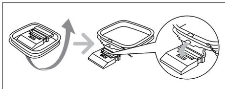
2 Conecte la antena tipo bucle **AM** en la toma **AM** de la parte posterior de la unidad principal.
