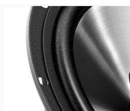
高度靈敏的布質喇叭圈將低音喇叭薄膜連接到喇叭框架，形成一個環迴懸掛系統。當聲音訊號到達低音喇叭內側的錐形筒時，布質喇叭圈配件將錐形筒還原到適當位置，以準備接收另一個聲音訊號。這樣，低音喇叭可以捕捉到每一個訊號，並將聲音失真降至最低，從而提供清晰、流暢的聲音，無論所播放的音樂的音量有多高或多低。
