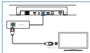
Koristeći optički kabl povežite **OPTICAL** priklučak na kućnom kinu sa **OPTICAL OUT** priklučkom na TV-u ili drugom uređaju.
