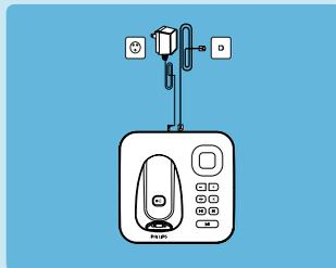
2. Conecte el cable de línea y el cable de alimentación a sus conectores correspondientes en la parte posterior de la estación base.
