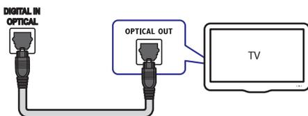
1. Izmantojot optisko kabeli, savienojiet **OPTICAL** ligzdu uz jūsu SoundBar atskaņotāja ar **OPTICAL OUT** ligzdu uz televizora vai citas ierīces.
