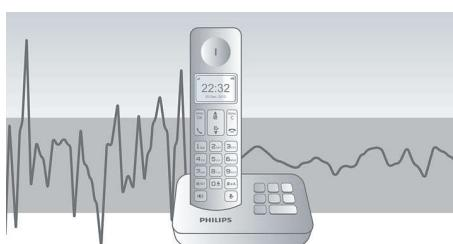
Автоматичното управление на силата на звука компенсира вариациите в звуковия сигнал, които може да са причинени от разстоянието, силата на сигнала или телефона на повикващия – така че това, което чувате, е с винаги постоянна сила. Усиливането на аудиото се понижава при силен сигнал и се повишава при слаб, така че
