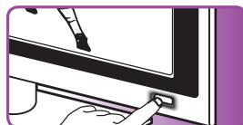
**2** Apăsați continuu tasta de selecție a dispozitivului (de ex. timp de 5 secunde până se aprinde LED-ul roșu pentru configurație.
