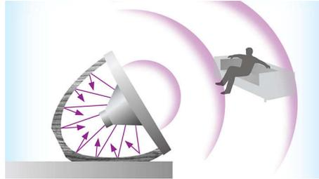
Die speziell entwickelte geschwungene Rückseite dieser Philips Dockingstation sorgt für eine sehr effektive Akustik bei der Soundwiedergabe. Die gänzlich geschwungene Fläche verstärkt die Stabilität des Lautsprechergehäuses. Somit wird die interne Resonanz drastisch verringert, und Vibrationen und Verzerrungen werden vermieden. Genießen Sie ausgezeichneten kristallklaren Klang über schicke Lautsprecher.
