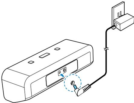
Conecte el adaptador de alimentación de CA: un extremo a la toma de corriente de la parte posterior de la unidad y el otro a la fuente de alimentación de pared.
