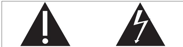
Значок молнии указывает на наличие неизолированных материалов в устройстве и опасность поражения электрическим током. В целях безопасности не снимайте корпус устройства.
