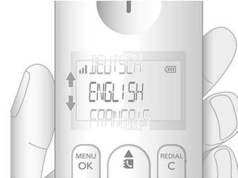
Das in bis zu sieben Landessprachen verfügbare intuitive Menü ermöglicht eine einfache Einrichtung, Navigation und Steuerung.
