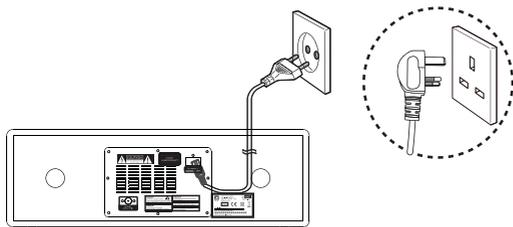
Conecte el cable de alimentación a la toma de corriente de la pared.
