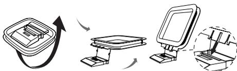
2 Ligue a antena de quadro MW (AM) à entrada **AMANT** na parte posterior do sistema Hi-fi.
