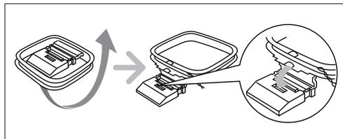
2 Conecte la antena tipo bucle AM en la toma **AM** de la parte posterior de la unidad principal.
