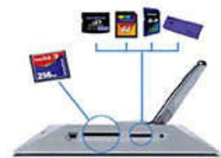
Der Memory-Card Manager verwaltet die zwei eingebauten Speicherkartenleser und bietet Softwarefunktionen zum direkten Anzeigen, Bearbeiten, Speichern und Organisieren der Fotos auf den Speicherkarten in einem einfachen Schritt – ganz ohne PC.
