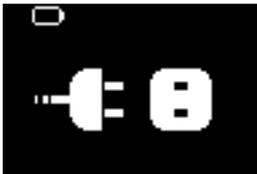
Das bedeutet, dass Sie Ihr Gerät über den Adapter/das Ladegerät (im Lieferumfang) an eine Steckdose anschließen müssen. Laden Sie Ihr Gerät für mindestens 30 Minuten auf (empfohlen wird 1 Stunde), und schließen Sie es anschließend an den Computer an, um Musikdaten zu übertragen. Behalten Sie das Ladezustandssymbol auf dem Display Ihres Gerätes im Auge.
