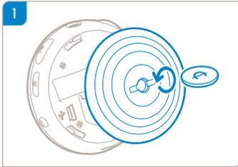
Mit einer geeigneten Münze gegen den Uhrzeigersinn drehen, um Rückabdeckung zu öffnen.
