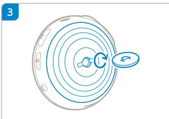
Laschen an Abdeckung an Schlitzlöcher am Gerät ansetzen. Vorsichtig im Uhrzeigersinn drehen, um Rückabdeckung wieder zu befestigen.
