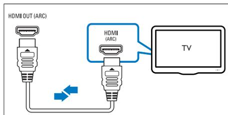
1 Collegare il connettore **HDMI OUT (ARC)** sul prodotto al connettore **HDMI ARC** sul TV mediante un cavo HDMI ad alta velocità.
