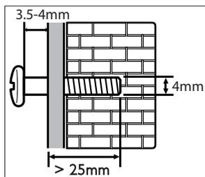
Vedere l'illustrazione nella guida di avvio rapido per il montaggio a parete del sistema SoundBar:
