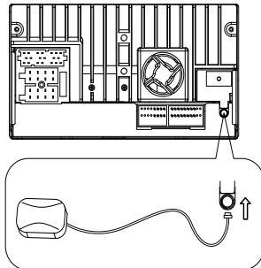
**2** 将 GPS 天线的另一端固定到汽车的金属表面。
