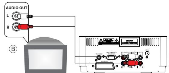
**B** Per ascoltare l'audio del televisore attraverso il lettore DVD, utilizzare un cavo cinch (non fornito) per collegare **AUX IN** sul pannello posteriore del lettore DVD ai rispettivi jack **AUDIO OUT** sul televisore.
