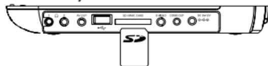
**TIP** Asegúrese de que la conexión metálica de la tarjeta que va a insertar esté mirando hacia abajo.
