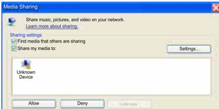
↳ Se il dispositivo sconosciuto non compare dopo circa un minuto, verificare che il firewall del computer non blocchi la connessione.
