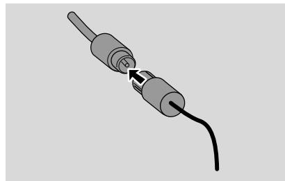
**Примечание:** Если вы используете кабельную антенну системы или внешнюю антенну, то их следует подсоединить в гнездо FM ANTENNA вместо проволочной антенны.
