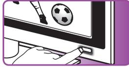
**2** Halten Sie die Geräteauswahlstaste (z. B.
