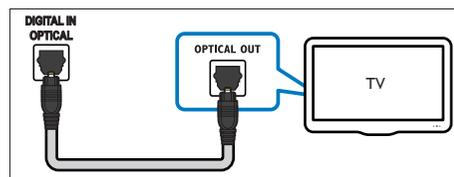
1 С помощью оптического кабеля подключите разъем **OPTICAL** домашнего кинотеатра к разьему **OPTICAL OUT** телевизора или другого устройства.
