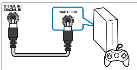
1 С помощью коаксиального кабеля подключите разъем **COAXIAL** домашнего кинотеатра к разьему **COAXIAL/DIGITAL OUT** телевизора или другого устройства.
