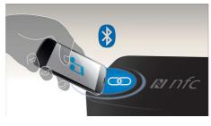
使用一触式 NFC (近场通信)技术轻松配 对蓝牙设备。只需用 NFC 智能手机或平板 电脑轻触扬声器的 NFC 区域打开扬声器, 便可启动蓝牙配对并开始传输音乐。
