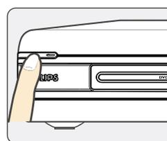
**3a** Нажмите **STANDBY-ON** на устройстве записи DVD для его включения.
