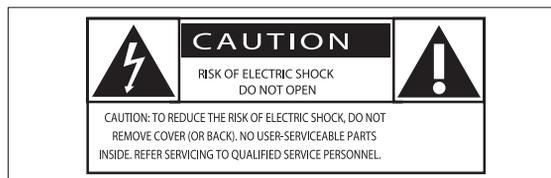
Il "fulmine" indica che il materiale non isolato nell'unità potrebbe causare una scossa elettrica. Per la sicurezza di tutti nell'ambiente domestico, non rimuovere la protezione dal prodotto. Il "punto esclamativo" richiama l'attenzione sulle funzioni per le quali è necessario leggere attentamente la documentazione allegata per evitare problemi di funzionamento e manutenzione.
