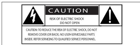
Il "fulmine" indica che il materiale non isolato nel dispositivo potrebbe causare una scossa elettrica. Per la sicurezza di tutti nell'ambiente domestico, non rimuovere la protezione.
