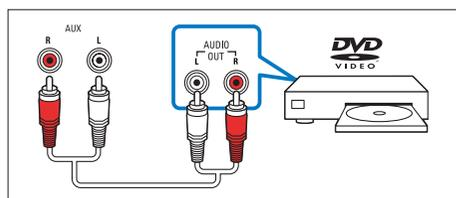
1 С помощью аналогового аудиокабеля подключите разъем **AUX** этого устройства к аналоговому аудиовыходу на внешнем устройстве.
