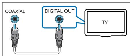
1 С помощью коаксиального кабеля подключите разъем **COAXIAL** этого устройства к коаксиальному выходу на телевизоре.
