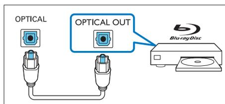
1 С помощью оптического кабеля подключите разъем **OPTICAL** этого устройства к оптическому выходу на внешнем устройстве.
