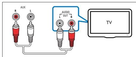
1 С помощью аналогового аудиокабеля подключите разъемы **AUX** этого устройства к аналоговому аудиовыходу на телевизоре.
