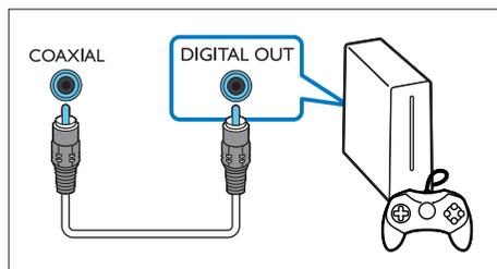
1 С помощью коаксиального кабеля подключите разъем **COAXIAL** этого устройства к коаксиальному выходу на внешнем устройстве.
