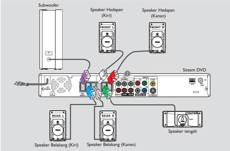
Sambungkan sistem speaker ke belakang sistem DVD dengan kabel speaker yang siap dipasang, padankan warna-warna bicu dan kabel speaker tersebut.
