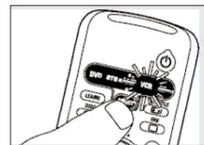
**2** Houd de toets LEARN en de toets op de SRU 5060 waaronder u de functie wilt opslaan **tegelijk gedurende 5 seconden** ingedrukt, tot VCR in het selector-venster tweemaal knippert en vervolgens blijft branden.
