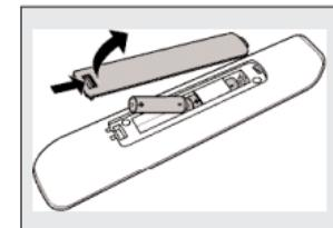
Huom.: Jos laitteen osoittimet valitsinikkunassa (DVD, STB, VCR, CD ja AMP) ja valmiustilan näppäin vilkkuvat neljä kertaa jokaisen näppäinpainalluksen jälkeen, kauko-ohjain osoittaa, että paristojen teho on alhainen. Korvaa vanhat paristot kahdella uudella AAA-tyyppisellä paristolla.
