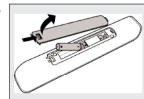
OBS: Om apparatindikatorerna i valfönstret (DVD, STB, VCR, CD och AMP) och väntelägesknappen blinkar fyra gånger varje gång en knapp trycks ner, angiver fjernbetjeningen, at dens batterier er ved at blive opbrugte. Byt ut de gamle batteriene mot två nya af AAA-typ.
