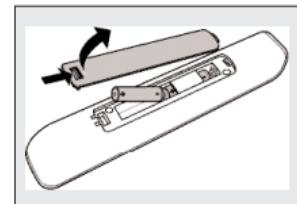
Bemærk: Hvis apparatindikatorerne i vinduet (DVD, STB, VCR, CD og AMP) og standby-knappen blinker fire gange efter hvert tryk på en knap, angiver fjernbetjeningen, at dens batterier er ved at være opbrugte. Udskift de gamle batterier med to nye batterier af AAA typen.
