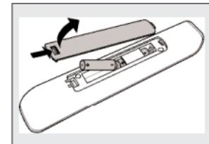
Remarque: Si les indicateurs d'appareil dans la fenêtre du sélecteur (DVD, STB, VCR, CD et AMP) et la touche de veille clignotent quatre fois après chaque pression de touche, c'est que la télécommande indique que ses piles sont faibles. Remplacez les piles par deux piles AAA neuves.
