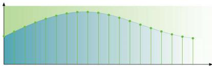
La frequenza di campionamento 192 kHz fornisce una rappresentazione accurata delle curve dell'audio originale. Insieme a una risoluzione a 24 bit, vengono acquisite ulteriori informazioni dalla forma dell'onda dell'audio analogico originale: ne consegue una riproduzione audio molto più intensa.
