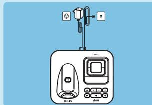
2. Conecte el cable de línea y el cable de alimentación a sus conectores correspondientes en la parte posterior de la estación base.
