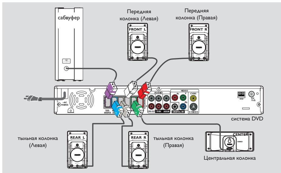
Подсоедините входящие в комплект колонки с помощью входящих в комплект кабелей. При этом цвета кабелей колонок должны соответствовать цветам разъемов. Неизолированный конец провода колонки вставляйте в разъем полностью.
