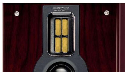
钕质带状高频单元是单极高频单元，从前方产生动态、清脆的声音。它是高端音频系统中常用的部件，可再现具有极高保真度的声音。传统的圆锥形和圆顶高频单元采用定向动圈原理，而钕质带状高频单元以 180 度辐射方式辐射高频。这样显著增大高音部分声谱的宽度，并扩展最佳听音的区域，即使是小型音频系统，也能产生宽广、晶晰而自然的声音。
