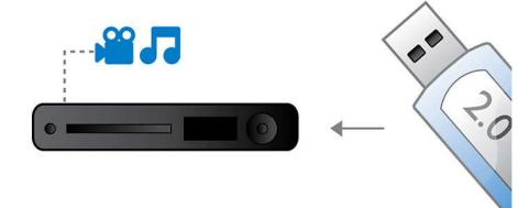
L'USB (Universal Serial Bus) est un protocole permettant de relier facilement des ordinateurs, des périphériques et des équipements électroniques grand public. Les appareils USB ultrarapides ont un taux de transfert de données allant jusqu'à 480 Mbit/s (il était de 12 Mbit/s sur les premiers appareils USB). Avec le port USB 2.0 ultrarapide, vous n'avez qu'à brancher votre appareil USB, sélectionner un film, un titre ou une photo et lancer la lecture.
