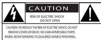
Il "fulmine" indica che il materiale non isolato nel dispositivo potrebbe causare una scossa elettrica. Per la sicurezza di tutti nell'ambiente domestico, non rimuovere la protezione.
