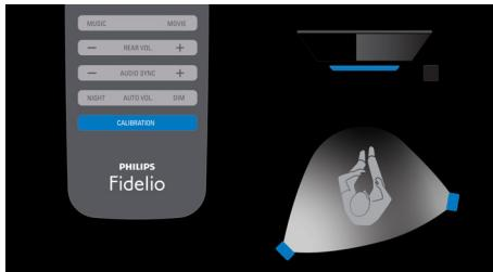
Funkcija napredne kalibracije u skladu s prostorom razvijena u našem jedinstvenom inovacijskom laboratoriju jamči najbolju moguću uravnotežnost zvučne slike, bez obzira na to gdje u prostoriji postavili stražnje zvučnike. Kada je pokrenete, funkcija će putem posebno dizajniranih zvučnih signala locirati stražnje zvučnike. Pomoću tih će informacija zatim identificirati najbolju ravnotežu zvuka za taj raspored zvučnika i u skladu s tim podešiti zvuk svakog zvučnika. Tako će slušatelj moći
