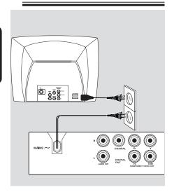
Une fois tous les raccordements effectués, branchez le cordon d'alimentation sur la prise secteur. Ne procédez jamais à des raccordements lorsque l'appareil est sous tension.
