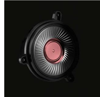
Les transducteurs avec contrôle du mouvement multicouche sont dotés d'un diaphragme en polymère à plusieurs couches dont une de gel amortisseur. Ces couches forment une surface non rigide qui absorbe et atténue les vibrations exagérées, de manière à produire une réponse en fréquences plus précise et uniforme et à obtenir une gamme de hautes fréquences plus équilibrée, naturelle et affinée.
