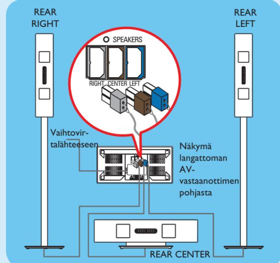
**Huomautus** Parhaan äänenlaadun varmistamiseksi tarkista, että langattoman AV-vastaanottimen ympärillä on tarpeeksi tilaa laitteen ilmanvaihtoa varten.
