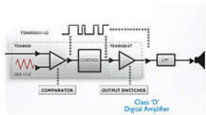
Amplification puissante et encombrement réduit ! L'amplificateur numérique de classe D convertit un signal analogique en signal numérique, puis l'amplifie numériquement. Ce signal traverse ensuite un filtre de démodulation avant d'atteindre la sortie finale. La sortie numérique amplifiée offre tous les avantages de l'audio numérique, par-dessus tout une meilleure qualité de son. De plus, l'amplificateur de classe D génère plus de 90 %
