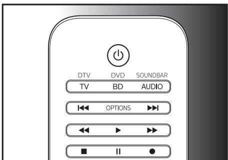
**6** Napravo upravljate z univerzalnim daljinskim upravljalnikom. Če se naprava pravilno odziva, ste vnesli pravo kodo. Sicer ponovite postopek od 2. koraka in uporabite drugo kodo na seznamu.
