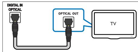
1 Menggunakan kabel optik, sambungkan penyambung **OPTICAL** pada teater rumah anda kepada penyambung **OPTICAL OUT** pada TV atau peranti lain.
