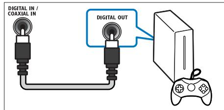
1 Menggunakan kabel sepaksi, sambungkan penyambung **COAXIAL** pada teater rumah anda kepada penyambung **COAXIAL/DIGITAL OUT** pada TV atau peranti lain.
