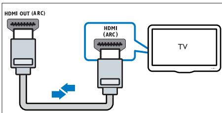
1 С помощью высокоскоростного кабеля HDMI подключите разъем **HDMI OUT (ARC)-TO-TV** на звуковой панели SoundBar к разъему **HDMI ARC** на телевизоре.
