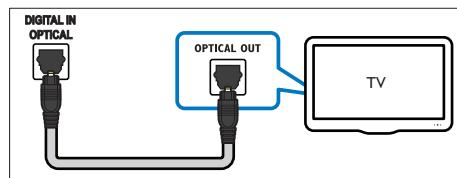
1 С помощью оптического кабеля подключите разъем **DIGITAL IN OPTICAL** панели SoundBar к разъему **OPTICAL OUT** телевизора или другого устройства.
