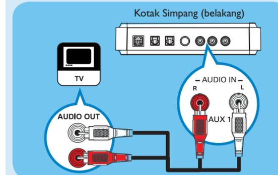
**Catatan** Untuk mendengar output audio dari sambungan ini, tekan **AUX/DI/MP3 LINK** berulang kali sehingga 'AUX 1 INPUT' dipaparkan pada panel paparan.
