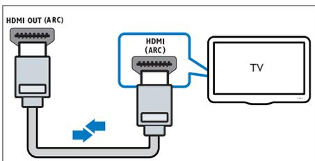
1 Verbinden Sie den **HDMI OUT (ARC)**-Anschluss an Ihrem SoundBar über ein Hochgeschwindigkeits-HDMI-Kabel mit dem **HDMI ARC**-Anschluss am Fernseher:
